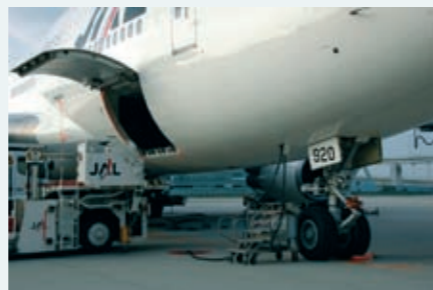
GPU(固定動力施設)
